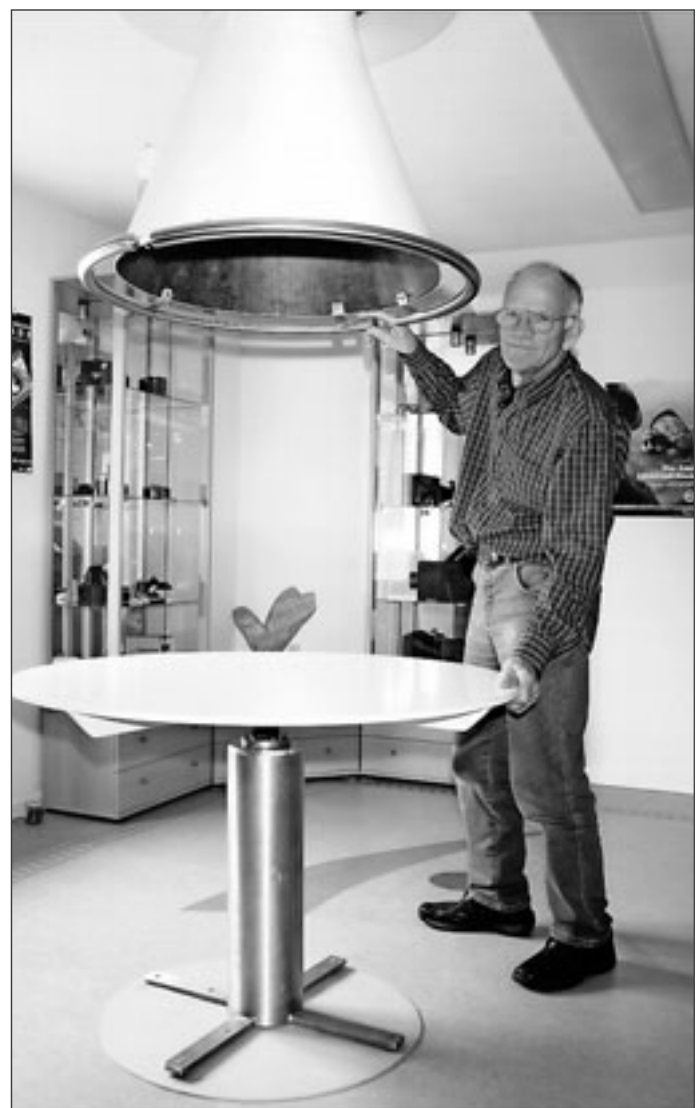
Blick in das Innere der Camera Obscura: Über das senkrechte Rohr werden Motive aus der Umgebung in das Innere gespiegelt und auf der Tischplatte sichtbar gemacht.
